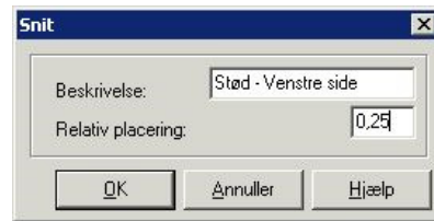
Figur 80: Indsættelse af snit i for stød i armeringen.
