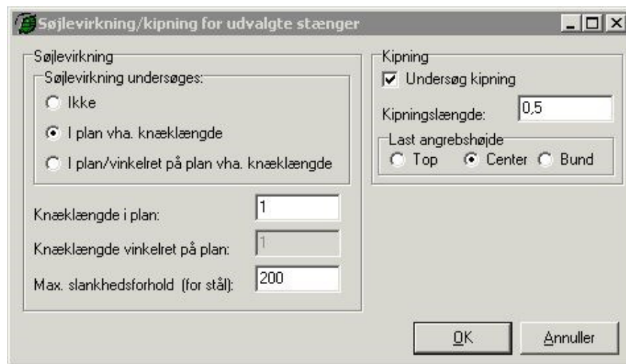
Figur 46: Søjlevirkning/kipning for øvrige stænger.
